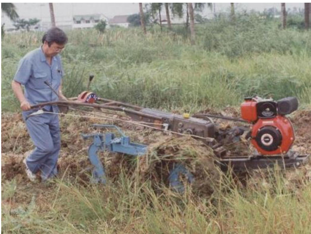
รูปที่ ๘ การทดสอบรถไถเดินตามต้นแบบในพื้นที่นา
