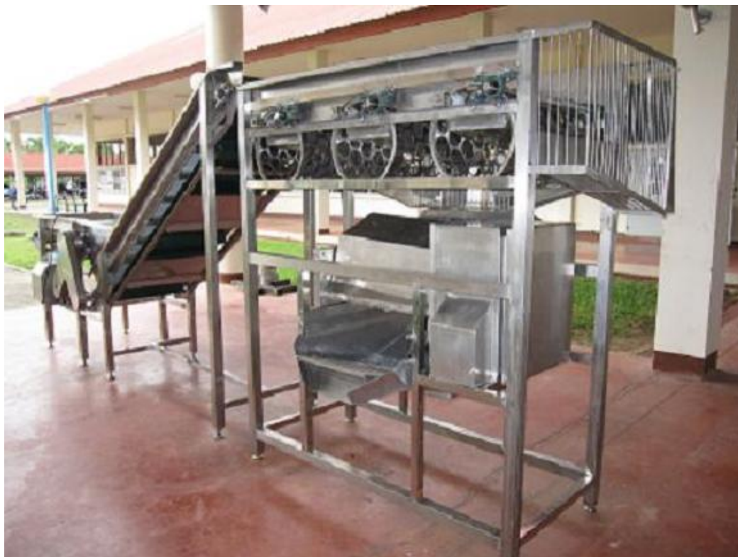
ที่มา : เครื่องต้นแบบ “เครื่องคัดขนาดและคั้นน้ำสั้มน้ำมะนาวที่คละขนาดกันสำหรับวิสาหกิจชุมชนขนาดเล็กและกลาง” นักประดิษฐ์ นายเสมอชัย ตันตีกุล คณะวิศวกรรมและอุตสาหกรรมเกษตร มหาวิทยาลัยแม่โจ้
