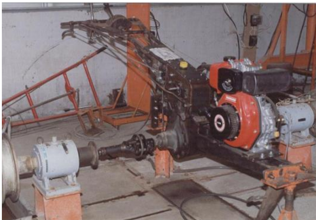
รูปที่ ๖ การทดสอบความทนทานของชิ้นส่วนส่งกำลังและกลไกของรถไถเดินตาม
